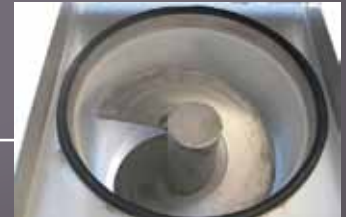
Vis d'Archimède inox avec tunnel recouvert de téflon.
